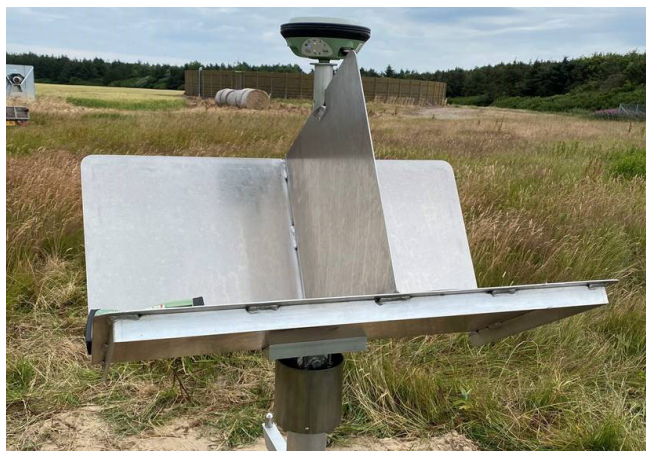
Dobbelt radarreflektor og Dynamisk Fikspunkt fra Geopartner Inspections.
