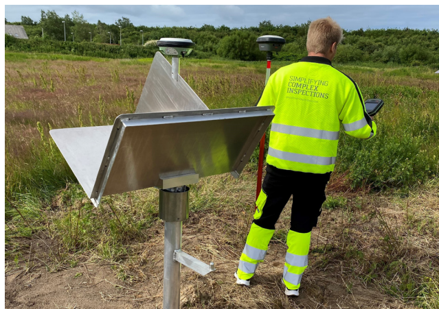
Enkeltstations RTK GPS måling med Det dynamiske fikspunkt som basestation.
