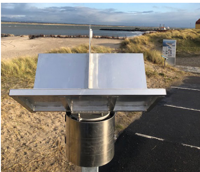
Billede 1: Fremtidssikret radarreflektor med indstillingsmuligheder.
