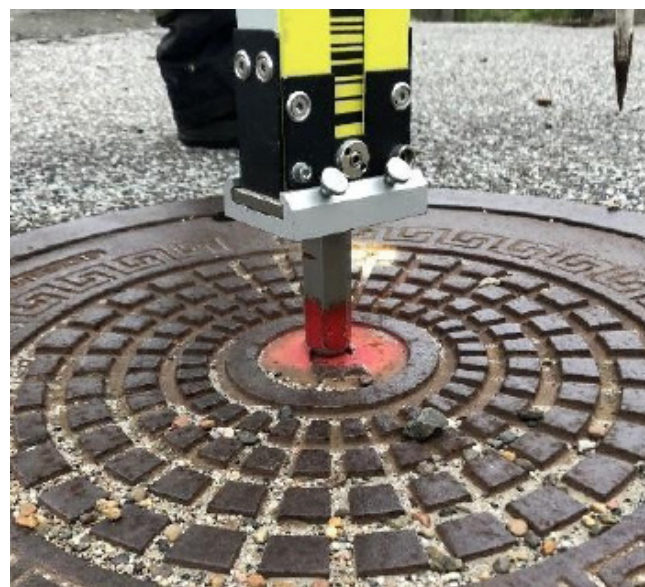
Figur 2: Stadiet med adapter på midten af brønddækslet, som er defineret som "målepunktet" på alle dæksler.
