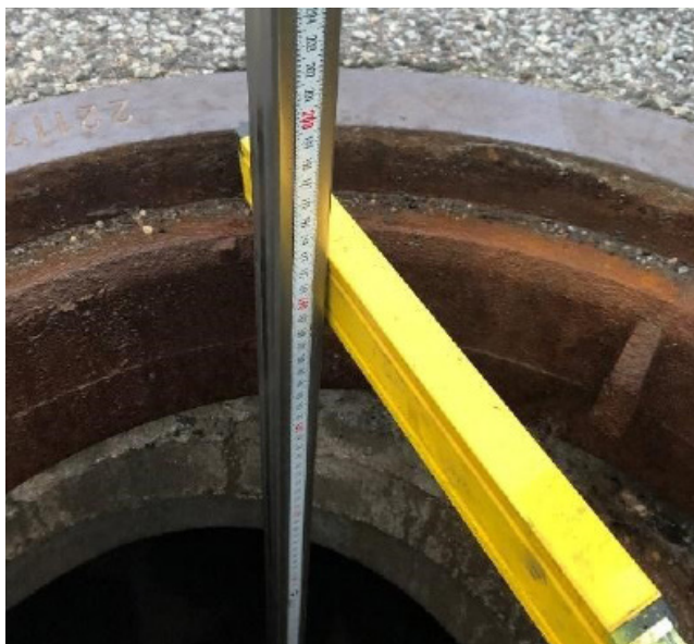
Figur 3: Princip for nedstiksmåling til bundløb i brøndmidte
