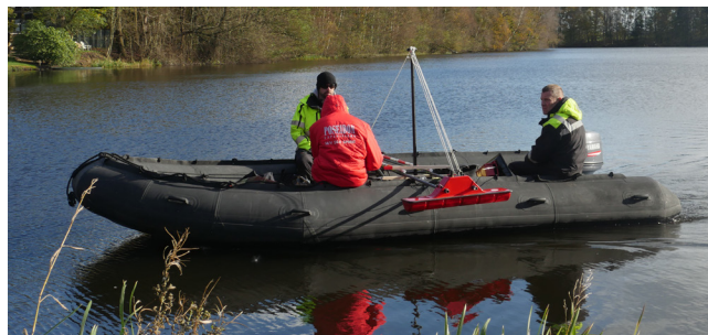
Billede 3: Dataindsamling for en sø med GPR og båd.
