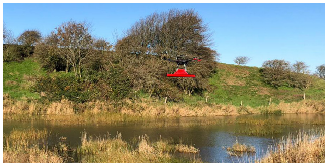
Billede 4: Dataindsamling for en sø med GPR og drone.
